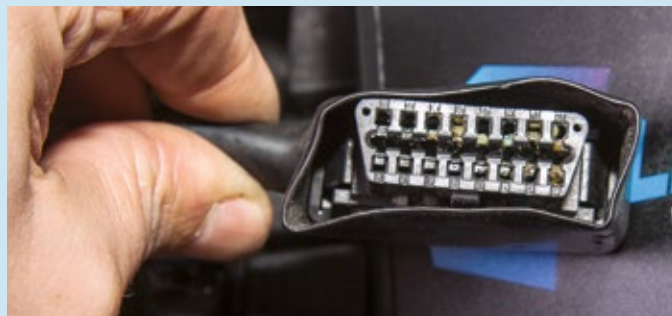
OBDII-Anschluss am Fahrzeug: Fett an den Pins kann die Verbindung zwischen Laptop und Steuergerät stören.
