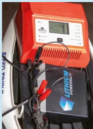
Ladestrom verhindert, dass die Bordspannung unter 12,5 V fällt.
