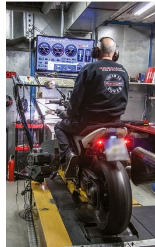
Nach zehn Messungen mit verschiedenen Drosselklappen-Öffnungswinkeln errechnet der Profi ein optimiertes Einspritz-Kennfeld. Tuner Mottier mobilisierte fünf PS an der Spitze (blaue Kurve) und sogar neun PS bei Teilöffnung der Drosselklappen.
