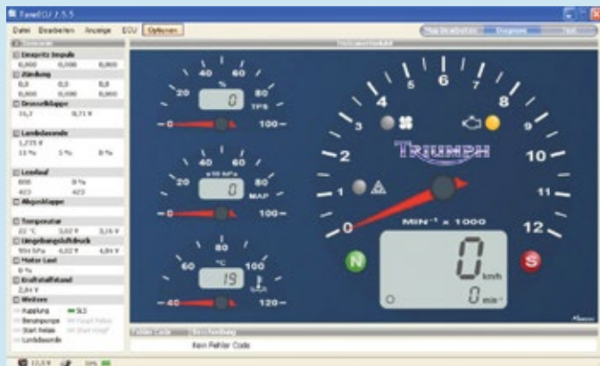
TuneECU-Gratis-Software: Hier können Drehzahl, Drosselklappenwinkel, Temperatur und viele andere Parameter abgelesen werden.
