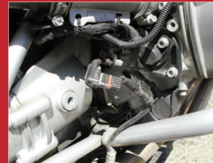
Die serienmäßige Lambdasonde (unten) wird gegen eine spezielle Breitbandsonde getauscht. Sie liegt dem Dynojet-Set bei
