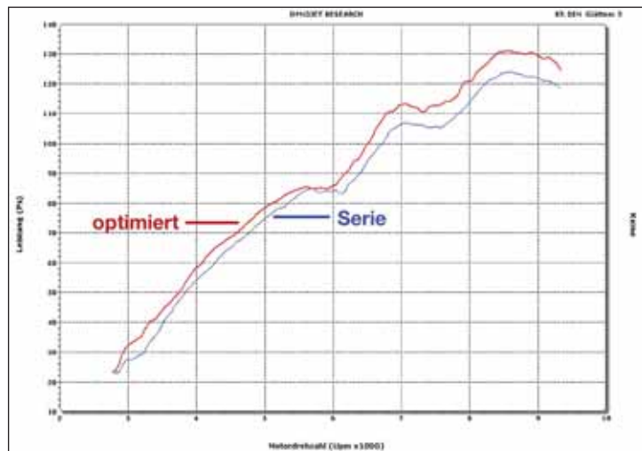
Leistungsdiagramm der abgestimmten Corsaro. Die hier gezeigten Kurven wurden am Hinterrad gemessen, sie liegen ca. 15% unter der DIN-Leistung.
