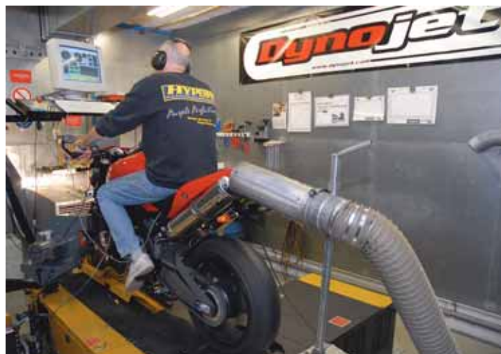
Bei einer Nachrüstung mit dem Powercommander wird zwar für jedes Modell ein Mapping mitgeliefert, das beste Ergebnis bringt aber erst eine Abstimmung auf dem Prüfstand wie hier bei Micron in Fürth-Sack.
