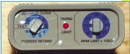
**10: Einfachste Bedienung: Zündkurven- und Retard-Gradszahl-Wahl per Drehschalter, dazwischen die Timing-LED**
