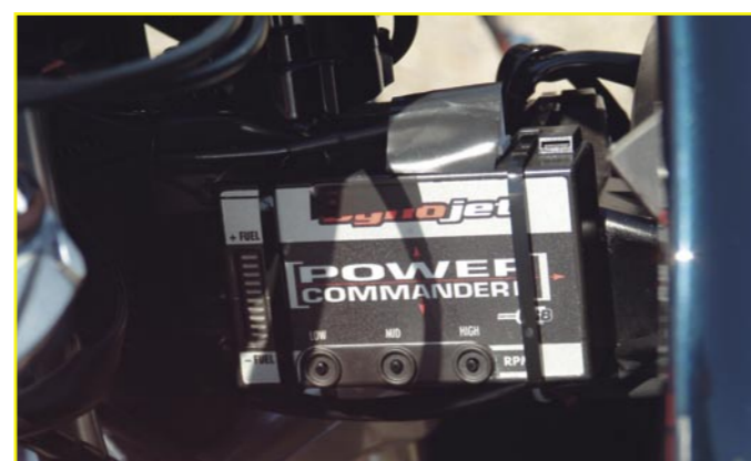
Düsentrieb: Der Power Commander ersetzt das Düsen-Sortiment vergangener Vergasertage
