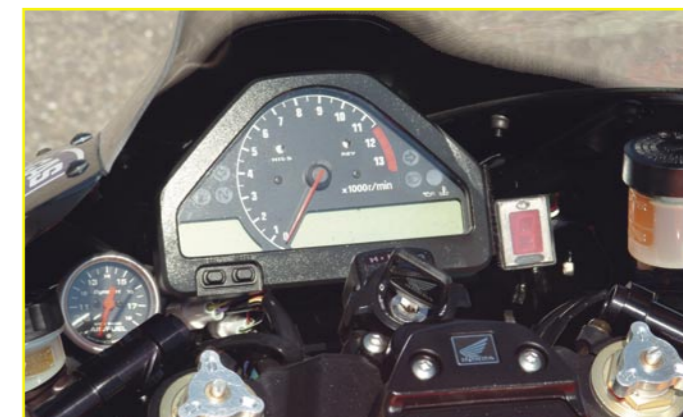
Uhrzustand: Analoge Anzeigen für Drehzahl und Lambda-Wert, digitale Ganganzeige
