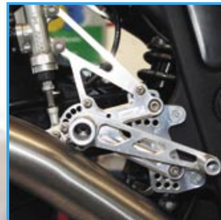
Das müßte reichen. Notfalls kann die Lucas-Anlage noch ein Loch höher gehängt werden.
