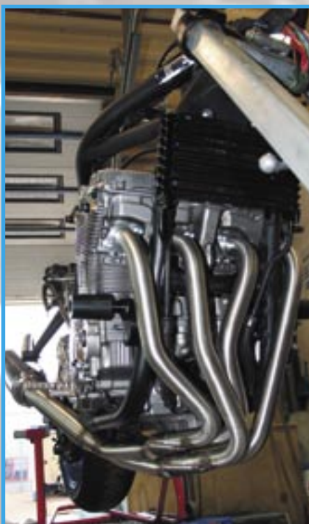
Ja, so sollte es sein. Doch nach der Montage des Endschalldämpfers wird es knapp für den Fuß.
