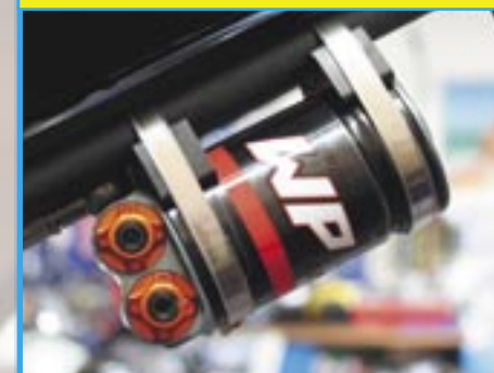
Optimal: 50cm Stahlflex und schon ist der Ausgleichbehälter gut bedienbar am Rahmenheck platziert.
