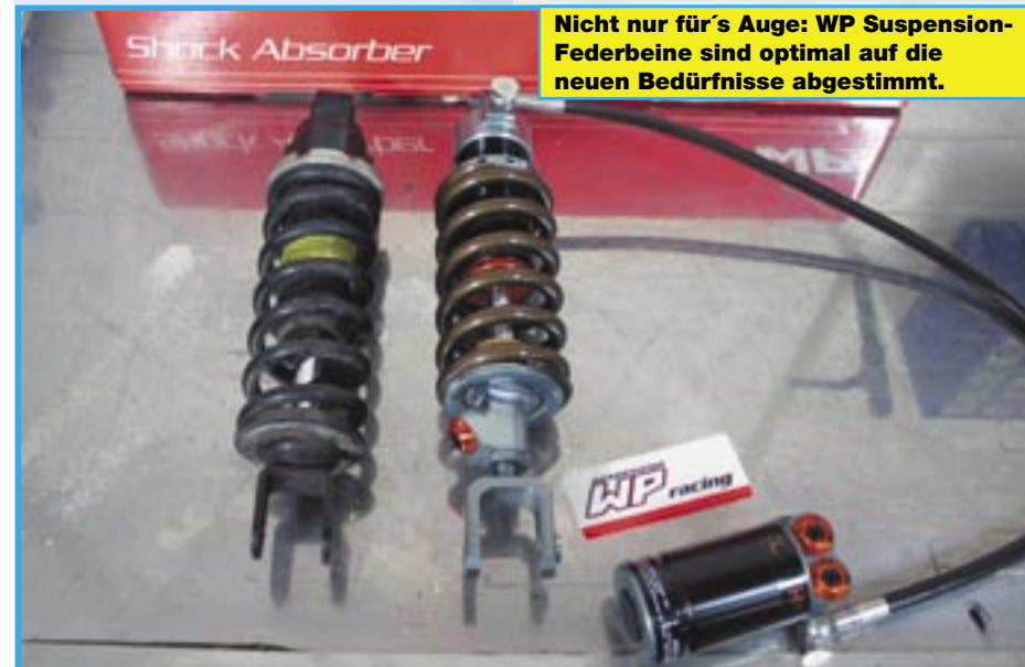
Optimal: 50cm Stahlflex und schon ist der Ausgleichbehälter gut bedienbar am Rahmenheck platziert.
