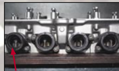
Letzte Feinanpassungen wurden am Kopf vorgenommen (sauberer Übergang zum Zylinderkopf).
