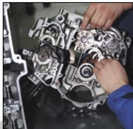
Beim Zusammenstecken der Motorhälften muß man besonders darauf achten, daß die Schaltgabeln an der richtigen Position sind.
