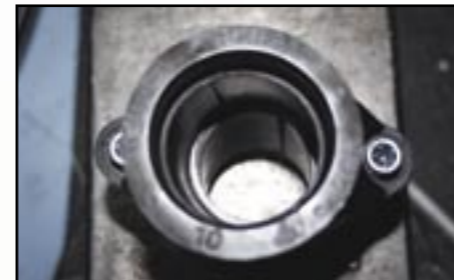
Anpassung: Damit der Bandit-Vergaser an den Zylinder paßt, muß der Ansaugstutzen auf das Innenmaß der GSX erweitert werden.
