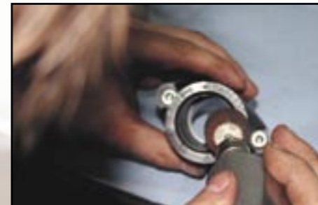
Mit dem Fächerschleifer geht es dem Stutzen ans Gummi. Hierfür wurden GSX- und GSF-Stutzen aufeinander geschraubt.
