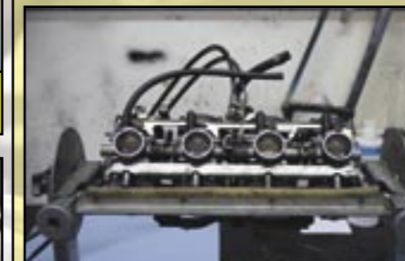
Die Vergaserbank wird zur Demontage fixiert.
