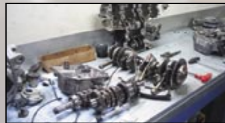
Pleuel- und Kurbelwellenlager werden getauscht. Hierbei muß genau auf die Farbmarkierungen geachtet werden.
