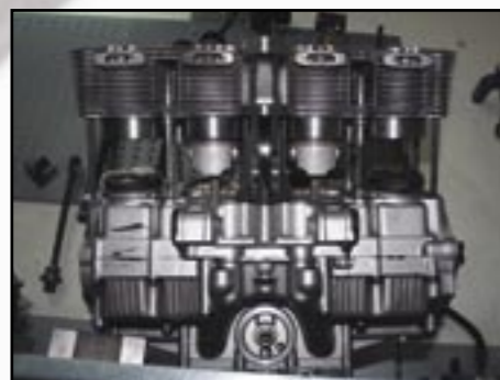
Die ersten GSX-Kolben sind schon an ihrem Platz, die anderen werden folgen.
