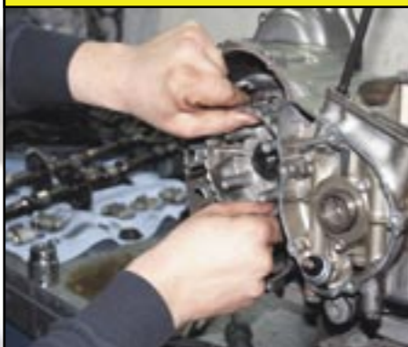
Der Kupplungskorb der Bandit hat starke Verschleißspuren und wird später gegen einen GSX-Korb getauscht.
