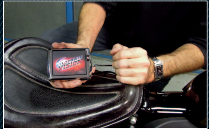
Das Power Vision-Steuergerät wird angeschlossen und verkabelt, die Daten anschließend neu aufgezeichnet
