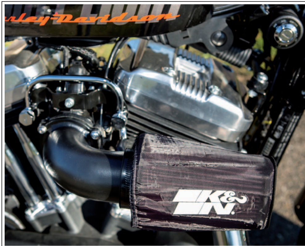
Das K&N Einlass-Kit mit Luftfilter bringt nicht nur mehr Leistung, es sieht auch sportlicher aus, als der langweilige Serien-Luftfilterkasten
