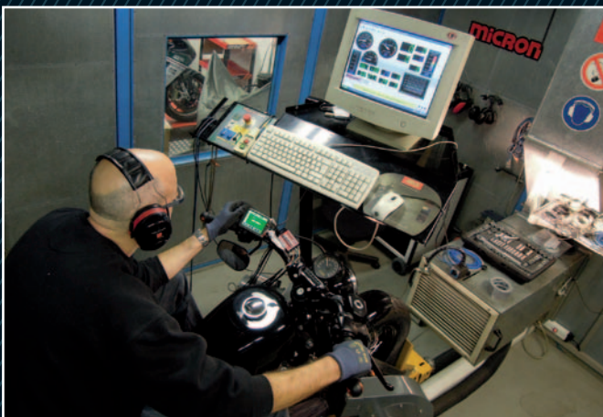
Vor dem Prüfstandslauf müssen die Daten des Seriensteuergeräts ausgelesen und das neue System konfiguriert werden
