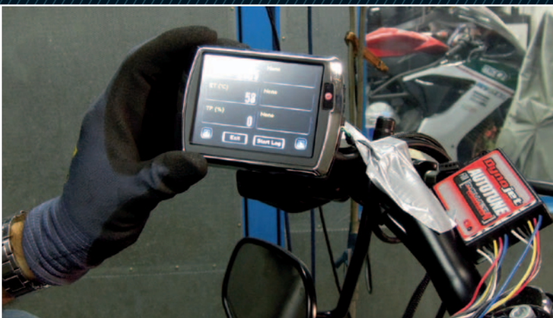
Vor dem Prüfstandslauf müssen die Daten des Seriensteuergeräts ausgelesen und das neue System konfiguriert werden
