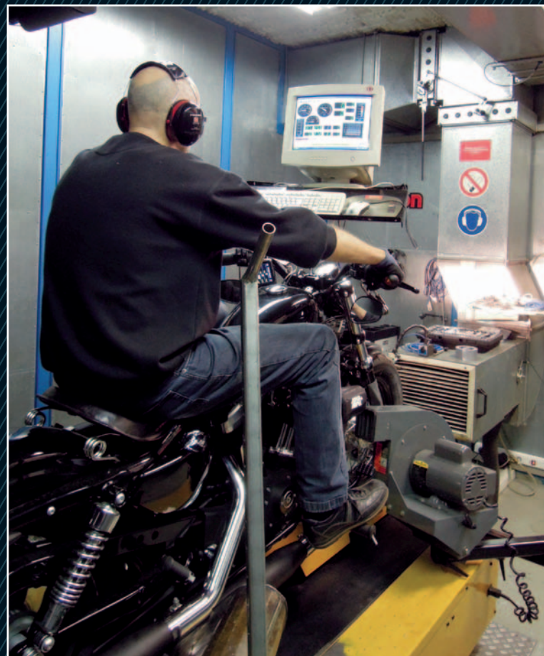
Alle Umbaumaßnahmen sind abgeschlossen, Steuergerät, Luftfilter und Auspuffanlage montiert. Abschließend wird das aufgezeichnete Kennfeld zur Datenerfassung abgefahren und neu berechnet
