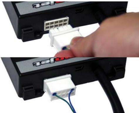
3. Verlegen Sie das Anschlusskabel zum Power Commander und schliessen es am WEISSEN Expansionsport an. Das Kabel so verlegen das es weder mit beweglichen oder heissen Teilen in Berührung kommt.
