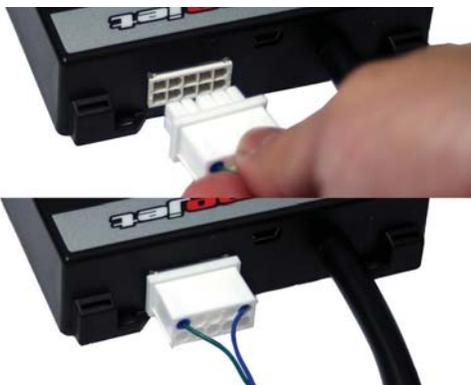
3. Verlegen Sie das Anschlusskabel zum Power Commander und schliessen es am WEISSEN Expansionsport an. Das Kabel so verlegen, das es weder mit beweglichen oder heissen Bauteilen in Berührung kommt.
