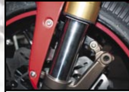
Zusatzhalter: Damit der XB-Fender nicht ungewollt rotiert, haben wir ihm noch einen zweiten Haltepunkt gegönnt.
