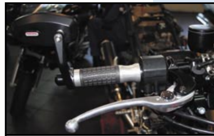
Durchdachte Bestückung: der BKG-Stummel umringt von Griff, Spiegel, Bremspumpe und Bremsflüssigkeitsbehälter
